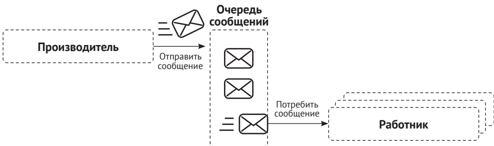
Рис. 8.16. Асинхронное исполнение с использованием очереди сообщений и работников
